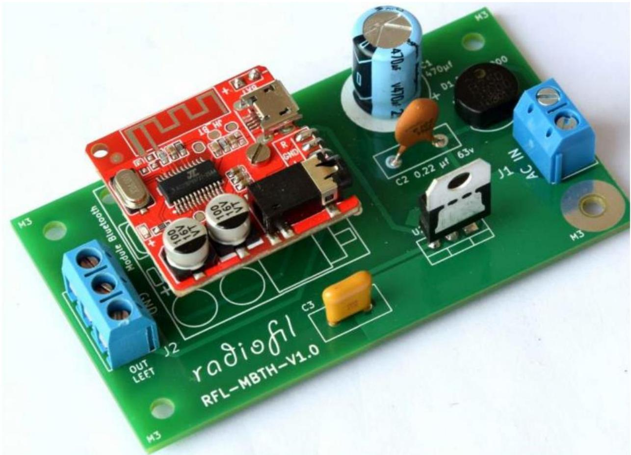
Conçu initialement pour le projet Amplifil MkII, ce petit module permet d'ajouter la connectivité Bluetooth à nos postes de radio en injectant son signal de sortie dans le circuit d'amplification BF.
