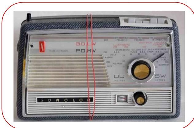
*Fig. V-19 : pour le cliché il a été choisi un fil rouge afin de bien montrer le principe. Un fil gris et fin permettrait d'éviter de rendre trop visible cette boucle de couplage formée ici de deux spires.*
