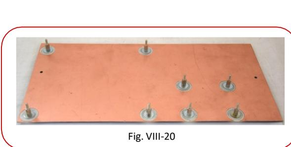
Après perçage, les trous sont fraisés pour ôter la couche de cuivre située à proximité (figure VIII-19). Cette précaution permet d'éviter les risques de bouclages des masses entre les modules, susceptibles de générer des bruits sur les porteuses. Ensuite des entretoises sont fixées pour recevoir les deux modules du kit.
