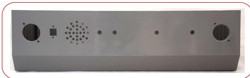
Figure VIII-11 : face arrière du boîtier, une fois l'usinage terminé.
