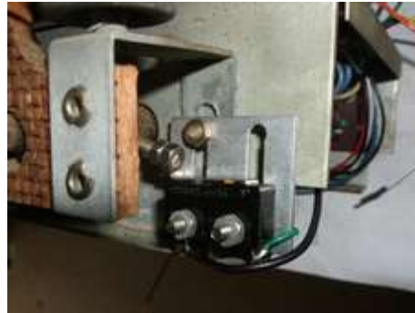
Figure 9b.-Même montage, mais avec une petite pièce réalisée et installée sur l'axe du commutateur de sélection de gamme
