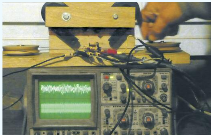
Figure 11. — Signal HF (trace inférieure) et signal détecté (trace supérieure) ▽
