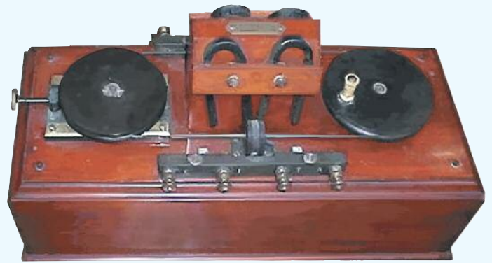
Figure 3. — Le détecteur magnétique de Marconi.
