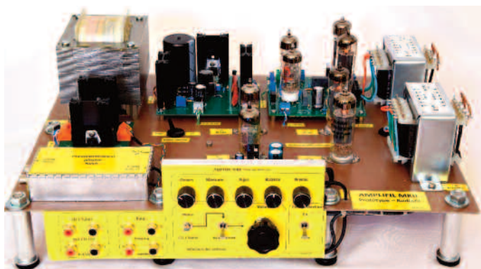
Face avant du prototype. Au fond, de gauche à droite : le transformateur d'alimentation, l'alimentation HT, le module de l'amplificateur et son transformateur de sortie (canal droit).
