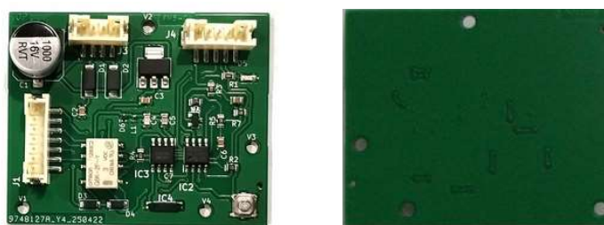
Figures1a et 1b.-Le circuit imprimé du module, recto et verso.
