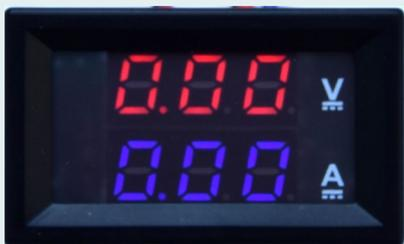
module de tableau de type voltmètre / ampèremètre.
