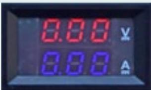
Pour environ 3 € à l'achat, nous testerons en détail les caractéristiques et les applications possibles de cet afficheur de tableau indiquant simultanément la tension et le courant alimentant un montage.
