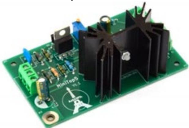
Module amplificateur de puissance 5 W. Alimentation directe en HT de 65 à 300 VDC.
