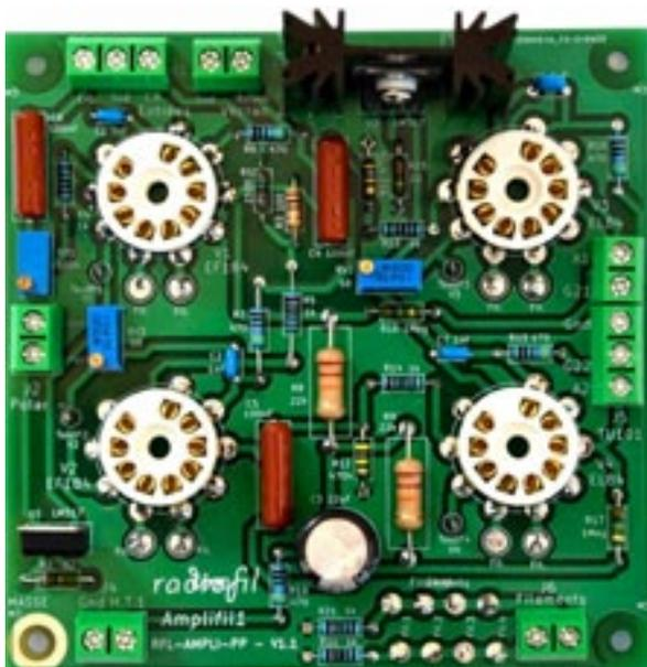
Module amplificateur de puissance à tubes (2 x EF184 + 2 X EL84) de haute qualité, pure classe A, puissance sinus : > 6 W RMS.
