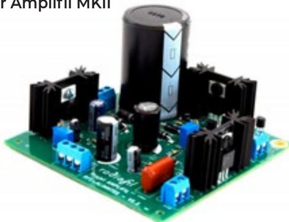
Module d'alimentation HT délivrant les tensions et courants nécessaires au fonctionnement d'un ou deux modules d'amplification à tubes de l'Amplifil MKII.
