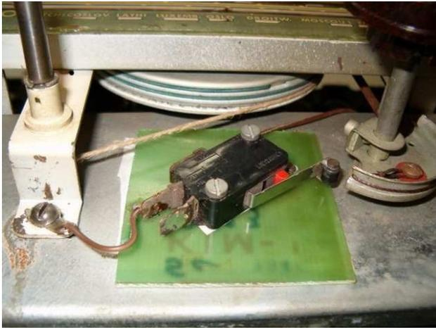
Figure 3a. - Un commutateur qui commande le plot J1.6.
