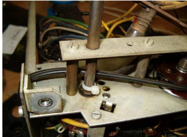
Figure 3b. - Un collier « colson » bien serré, puis collé avec de la colle instantanée (super glue). Ce collier va toucher le levier du commutateur.
