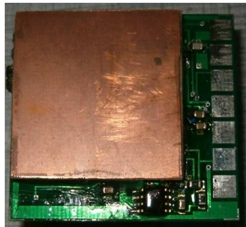
Figure 4. – Collage du carré de façon que les bornes de la platine restent libres.
