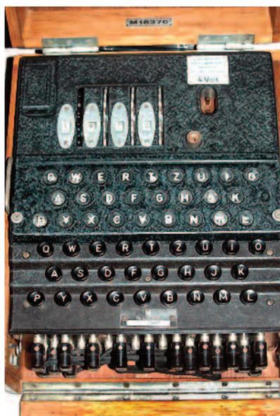
électrique. Puis, le message chiffré est envoyé en Morse. En plus des rotors, il y a des « Steckers », des cordons à enficher qui permutent des lettres. Le système de décodage appelé « bombe » est une machine électromécanique !
