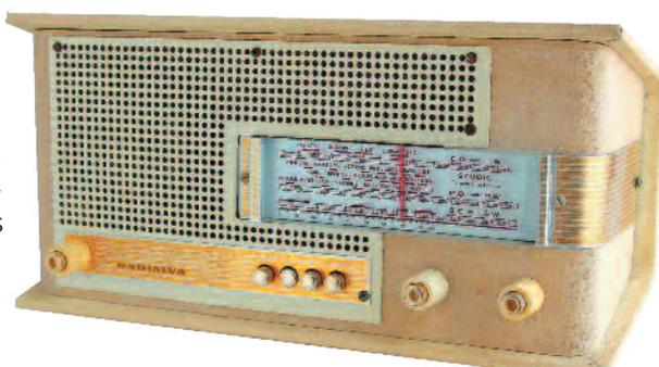
fret est en bois contreplaqué avec gainage extérieur collé. Le câblage est hybride, partie sur barrette à cosses, partie sur deux petits circuits imprimés.
