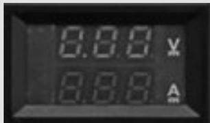
Pour environ 3 € à l'achat, nous testerons en détail les caractéristiques et les applications possibles de cet afficheur de tableau indiquant simultanément la tension et le courant alimentant un montage.
