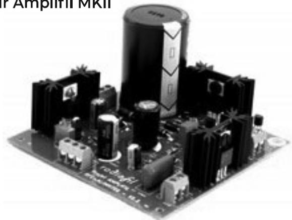
Module d'alimentation HT délivrant les tensions et courants nécessaires au fonctionnement d'un ou deux modules d'amplification à tubes de l'Amplifil MKII.
