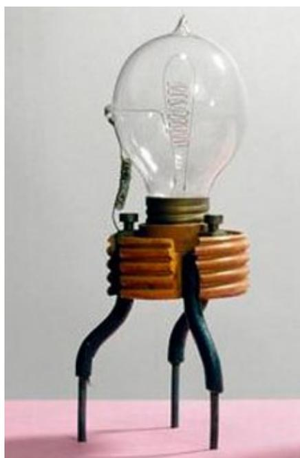
Figure 5 - La diode de Fleming
